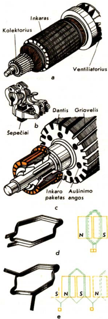
10.10 pav. Nuolatinės srovės mašinos inkaras su kolektoriumi (a), šepečiai ir jų laikikliai (b), inkaro magnetolaidis ir kolektoriaus pjūvis (c), inkaro kilpinės (d) ir banginės (e) apvijų sekcijos su jų schemomis.
