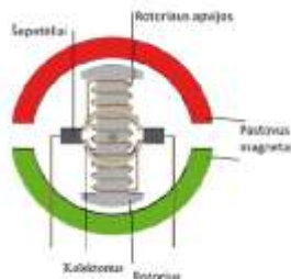
2 pav. Nuolatinės srovės elektros variklio su šepetėliais schema
