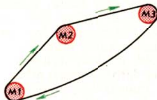
13.4 pav. Konvejerio susietoji pvara (M – varikliai su reduktoriais)
