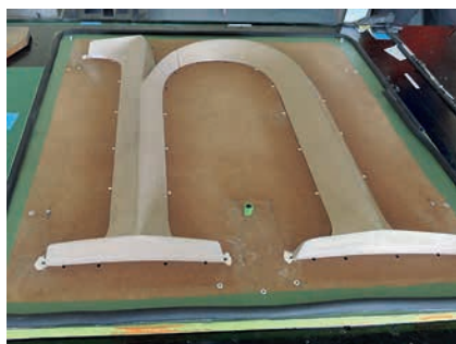
85 pav. Tūrinės raidės formavimas: 1 – tūrinės raidės formavimui paruošta forma; 2 – iš organinio stiklo suformuota tūrinė raidė (nuotr. iš asmeninio autorės archyvo)
