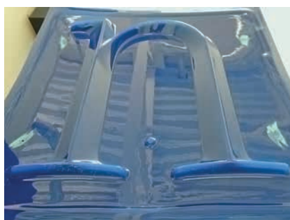
85 pav. Tūrinės raidės formavimas: 1 – tūrinės raidės formavimui paruošta forma; 2 – iš organinio stiklo suformuota tūrinė raidė (nuotr. iš asmeninio autorės archyvo)
