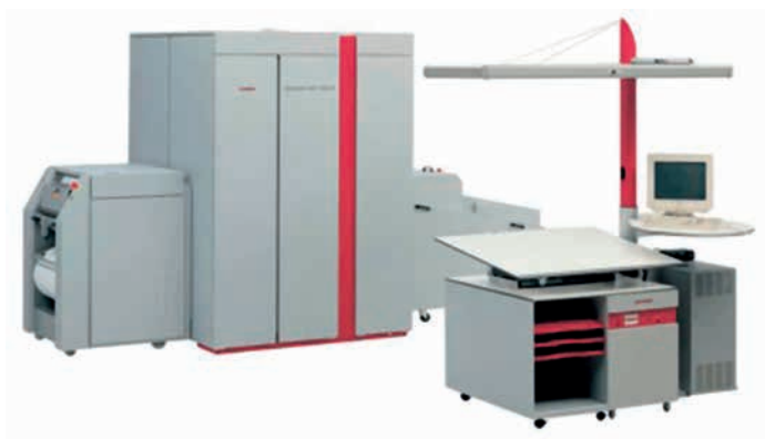
57 pav. Aštuonių spaudos sekcijų „XEIKON 500 DCP“ (ruloninė spauda) – 7800 kopijų/val. [58]
