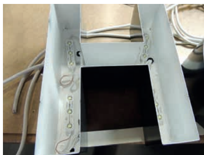
84 pav. Į tūrinę raidės dėžę montuojamas šviesos diodų apšvietimas (nuotr. iš asmeninio autorės archyvo)
